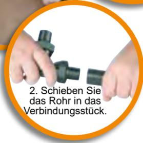
2. Schieben Sie das Rohr in das Verbindungsstück.
