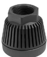
**Maximal zulässiger Druck:** 16 bar • **UV-beständige Materialien** • **Körper:** Nylon verstärkt mit Glasfaser • **Frühling:** Edelstahl • **Zwerchfell:** Nitrilkautschuk.
