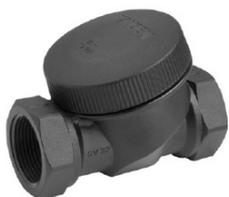
**Maximal zulässiger Druck:** 10 bar • **Mindestöffnungsdruck:** 0,035 bar • **UV-beständige Materialien** • **Körper:** Nylon verstärkt mit Glasfaser • **Frühling:** Edelstahl • **Zwerchfell:** Nitrilkautschuk.
