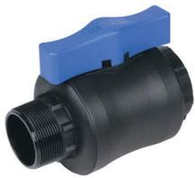
**Maximal zulässiger Druck:** 16 bar • **UV-beständige Materialien** • **Körper und handhaben:** Nylon verstärkt mit Glasfaser • **Ball:** PP • **Sitz:** Acetalharz (POM) • **Dichtungen:** Nitrilkautschuk.
