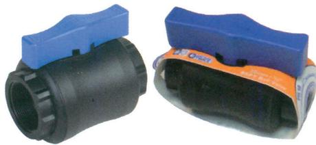
**Maximal zulässiger Druck:** 16 bar • **UV-beständige Materialien** • **Körper und handhaben:** Nylon verstärkt mit Glasfaser • **Ball:** PP • **Sitz:** Acetalharz (POM) • **Dichtungen:** Nitrilkautschuk.
