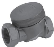
**Pressione max ammissibile:** 10 bar • **pressione minima d'apertura:** 0,035 bar • **materiali** resistenti agli UV • **corpo:** nylon rinforzato fibra vetro • **molla:** acciaio inossidabile • **diaframma:** gomma nitrilica.
