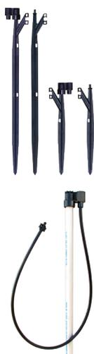
Il Riser Stake di Senninger è disponibile nei modelli da 26" o 14" di lunghezza per supportare il Riser Adapter Senninger per l'uso con un irrigatore di connessione NPT da 1/2" M o ugello. Può essere utilizzato anche per il montaggio diretto di un irrigatore con base a innesto in tubi da 0,25", 0,270" o 8 mm.
