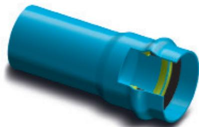
Visione assonometrica tubo PVC-A con guarnizione Forsheda Powerlock preinserita meccanicamente a caldo durante la fase di bicchieratura del tubo
