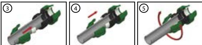
3. Insérez le tuyau dans le raccord jusqu'à la butée - assurer que le tuyau passe à travers le joint o-Ring
